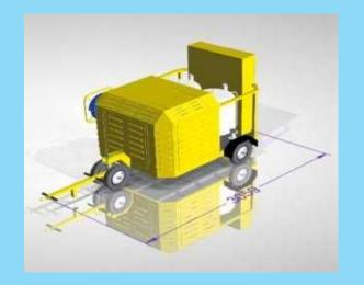
El equipo consta de un generador eléctrico impulsado por un motor de combustión interna a gasolina, 2 tanques de agua con capacidad para almacenar 130 litros (34 USG), cada uno equipado con un sistema de calentamiento de agua a base de 2 resistencias eléctricas y un sistema de bombeo; esta unidad cumple con los requisitos establecidos en los programas de mantenimiento estándar de las aeronaves comerciales.
